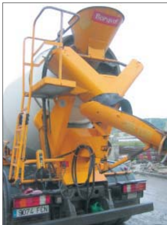
Escalera de acceso a la tolva
