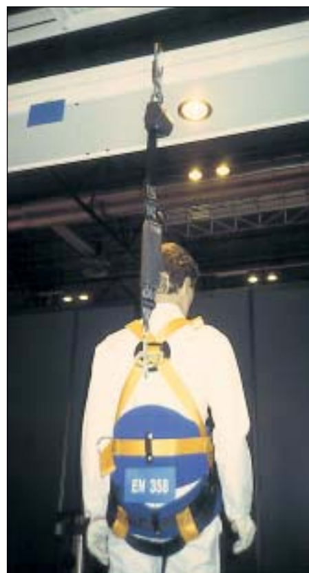
Absorbedor de energía (banda de desgarro)
