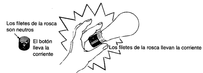
Figura 16-9 Riesgos de la polaridad invertida en el receptáculo de una lámpara: (a) receptáculo alambrado correctamente; (b) receptáculo con polaridad invertida.
