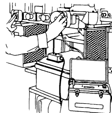
Figura 14-29 Dispositivo de medición de tiempo de frenado.
