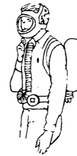
Figura 11-6 Aparato de respiración independiente de circuito abierto.
