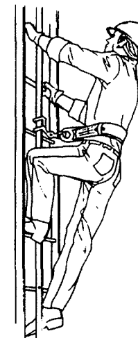
Figura 7-4 Ejemplo de un dispositivo de seguridad para escaleras.
