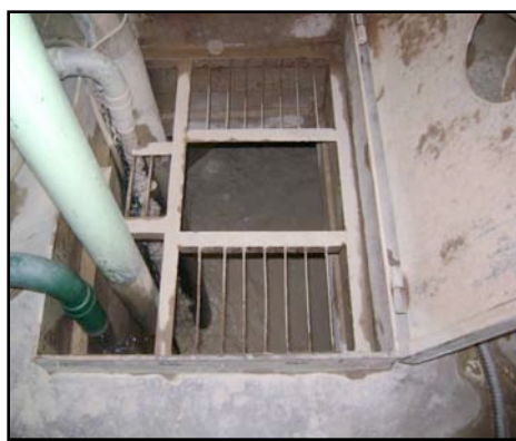
Balsas (fosas de concreto bajo nivel de piso) de almacenamiento donde llega la barbotina que mandan los turbodiluidores.
