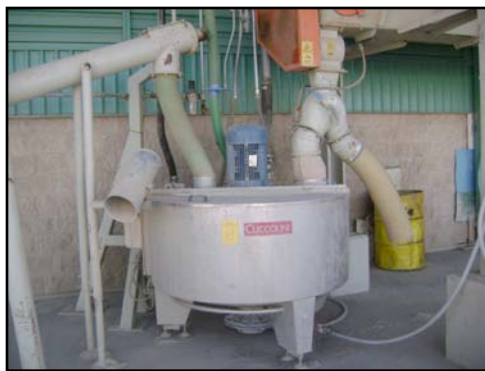
Generación de barbotina de los turbodiluidores que se envía a las balsas (tanques de concreto bajo tierra) de almacenamiento.
