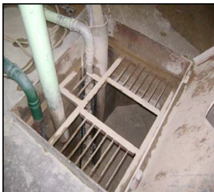
Balsas (fosas de concreto bajo nivel de piso) de almacenamiento donde llega la barbotina que mandan los turbodiluidores.
