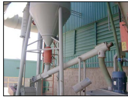
Generación de barbotina de los turbodiluidores que se envía a las balsas (tanques de concreto bajo tierra) de almacenamiento.
